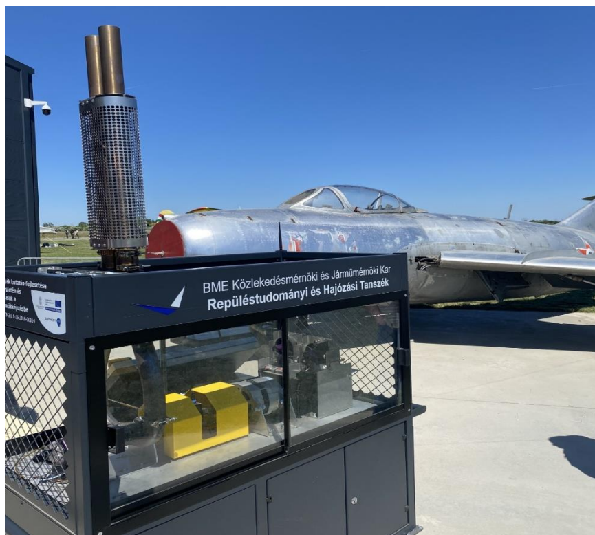
8. ábra. A tanszék új kisméretű gázturbina demonstráló eszköze
